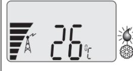
4. Wenn das Antennensymbol
